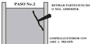
En grietas o fisuras verticales, soplear con aire a presión para retirar partes flojas o sueltas. Sobre la grieta o fisura haga un barreno a cada 15 o 20 cm sobre la grieta con un diámetro de 3/8" y con una inclinación de 15 positivos. Inserte nuestros puertos de inyección **UREFOAM INYECTOR BANG** (Puerto de inyección plástico de colocación por golpe).
